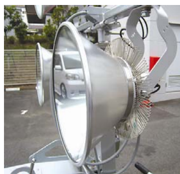
今回、新たに製作した完全防雨仕様のオリジナルリフレクター。
