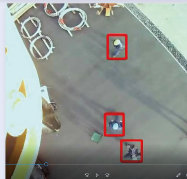
人(作業員)がセンサー範囲内に入ると赤い囲み線で表示
