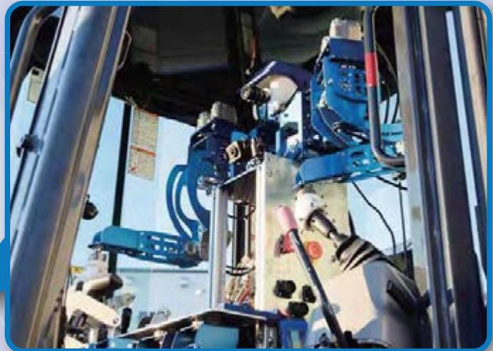
建機に搭乗するのはロボットのため、災害時などに人が入っていけないような場所での重機作業が可能となります。国土交通省が実施した「次世代社会インフラ用ロボット開発・導入現場実証」に参加し、その有用性は実証済みです。
