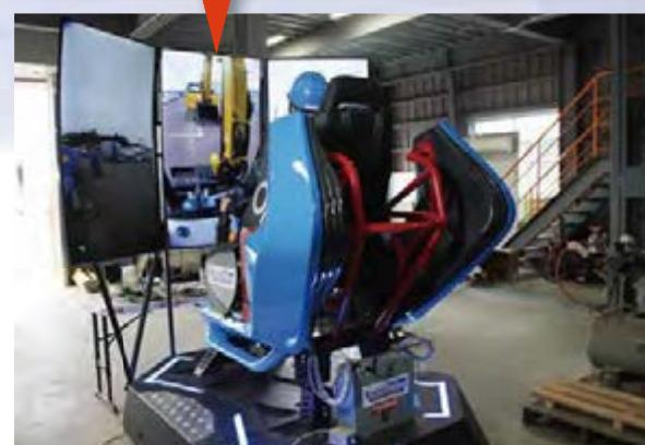
Kana Robo本体と建機に取り付けた高性能カメラからの映像を映す「55型3画面ディスプレイ」を設置。大画面で現場の状況を確認しながら、精密で確実な作業が行えます。
