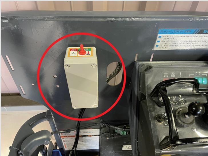
マグネット固定式の解除スイッチをバケットに取り付けます。トグルスイッチを押している間のみ解除状態となり、操作可能となります。スイッチを離すと再度センサーが働き、操作ができなくなります。
