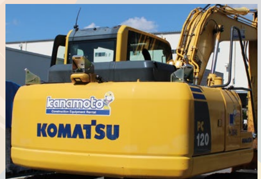
対象との距離を正確に計測するカメラからの映像をAIが自動解析し、センサー範囲内に人を検知すると強制停止またはアラート通知するシステム。写真上は汎用建設機械に設置する「ナクシデント」、写真左はクレーンフックに設置する「AIスコープ」 System for Automated AI Analysis of Camera Images Precisely Measuring Distances to Force Stoppage or Alert Personnel of Persons Detected within the Sensor Range; Top photo: Naccident Installed on General-purpose Construction equipment; Left photo: AI Scope Installed on a Crane Hook
