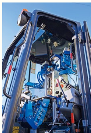
建設機械の無人操縦を実現する遠隔操縦装置。写真上と左は運転席に人型ロボットを設置する「Kana Robo」、写真下2枚はハンドルやペダルなどに独自の操作機構を設置する「Tunnel RemOS-WL (西松建設・カナモト・ジオマシンエンジニアリングの3社共同開発)」とともにコックピット型コントローラで無線操縦するシステム Remote Control Cockpit Realizing Unmanned Operation of Construction Equipment Top and left photos: Kana Robo Humanoid Robot in Cockpit; Bottom two photos: Unique Tunnel RemOS-WL system with levers, pedals and other controls (jointly developed by Nishimatsu Construction, Kanamoto and GM Engineering) to Use as a Cockpit for Remote Control
