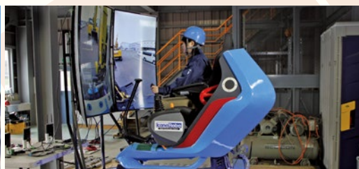
建設機械の無人操縦を実現する遠隔操縦装置。写真上と左は運転席に人型ロボットを設置する「Kana Robo」、写真下2枚はハンドルやペダルなどに独自の操作機構を設置する「Tunnel RemOS-WL (西松建設・カナモト・ジオマシンエンジニアリングの3社共同開発)」とともにコックピット型コントローラで無線操縦するシステム Remote Control Cockpit Realizing Unmanned Operation of Construction Equipment Top and left photos: Kana Robo Humanoid Robot in Cockpit; Bottom two photos: Unique Tunnel RemOS-WL system with levers, pedals and other controls (jointly developed by Nishimatsu Construction, Kanamoto and GM Engineering) to Use as a Cockpit for Remote Control
