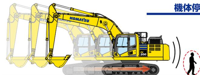
停止状態から走行するとき、また走行中（低速のみ）でも、停止制御エリアで人を検知すると走行を停止します。
