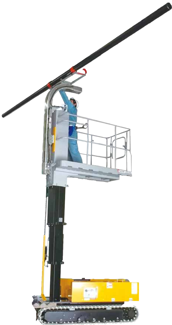
配管荷揚げイメージ
