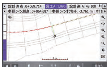
杭打ち画面(ライン)
