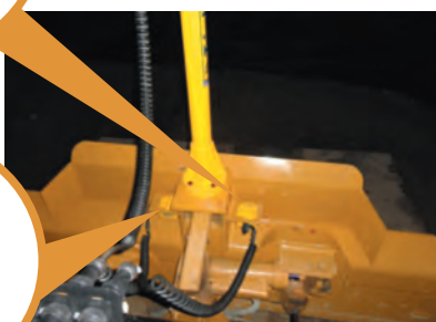
ピッチ・スロープセンサー (設置例)
