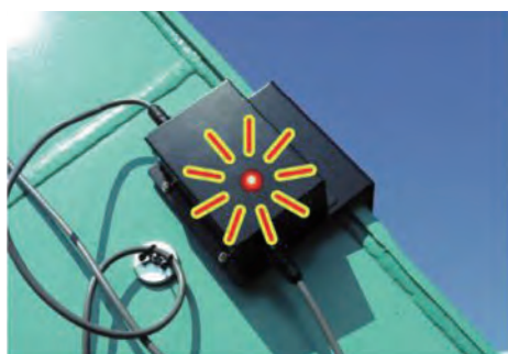
傾斜検出センサ(光(LEDで警報))
