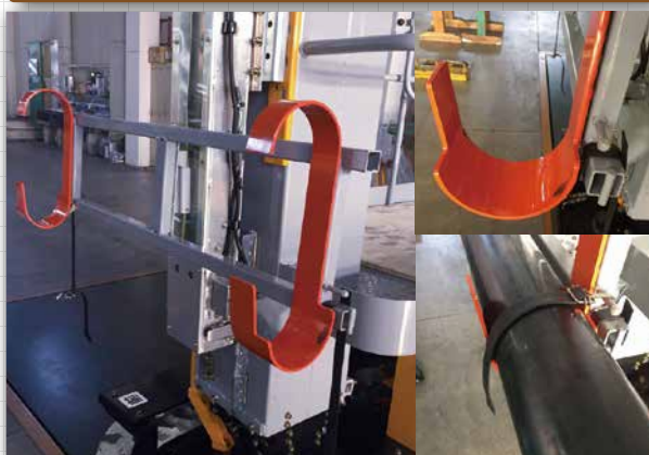
配管アタッチメント部分
