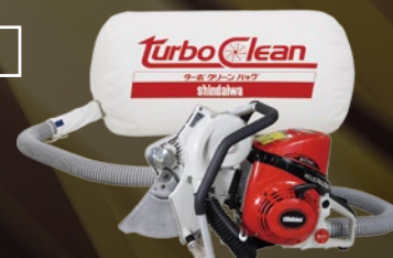
12インチ 集塵タイプ ECLD7412BS ダイヤモンドブレード装着時 φ320mm、切込深さ 130mm
