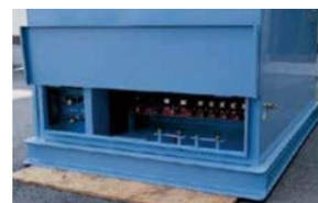
一次側キャブタイヤ取付部
