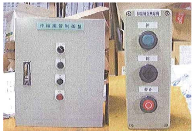
制御盤、リモコンスイッチ
