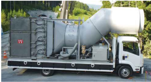
M-ECX2400 エコクリーン X (処理風量: 2,400m 3 /min)
