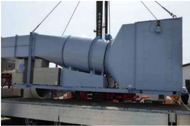
M-ECXV3000 エコクリーン XV (処理風量：3,000m 3 /min)
