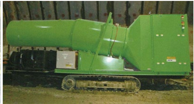
M-ECX2400 エコクリーン X (処理風量: 2,400m 3 /min)
