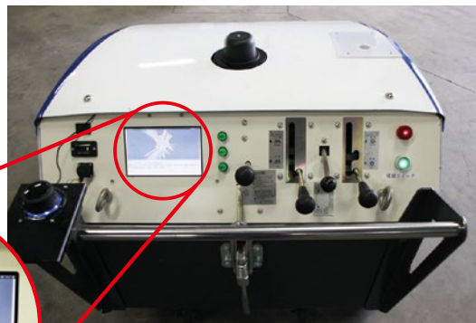
操作パネルでセンサーマーカの設置状態などを確認しながら自動運転の設定を行います。
