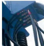
偏心モーメント制御配管部
