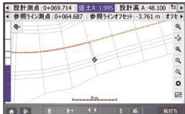
杭打ち画面(ライン)
