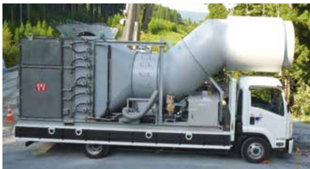
エコクリーン X (処理風量 : 2,400m 3 / min)
