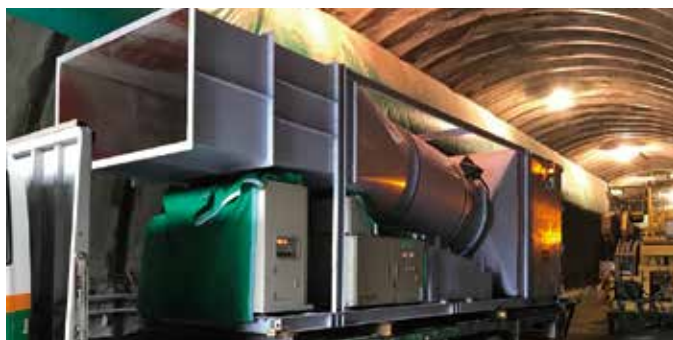
大型電気式集塵機(トラック積載状況)
