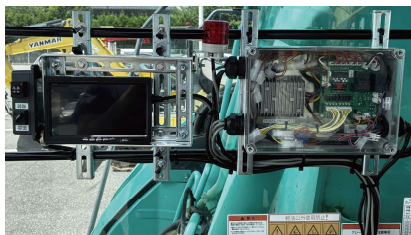
モニターと制御 PC ボックス（キャビン内）
