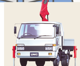
■クレーン付トラック
