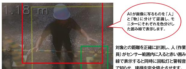
手だけ、脚だけでも「人」として認識する高精度なセンサーシステム
