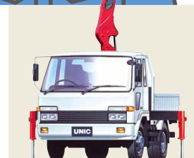
■クレーン付トラック
