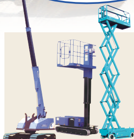
■室内高所作業車・作業台
